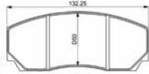
Plaquettes CP3215D50 Épaisseur 16,8 mm
